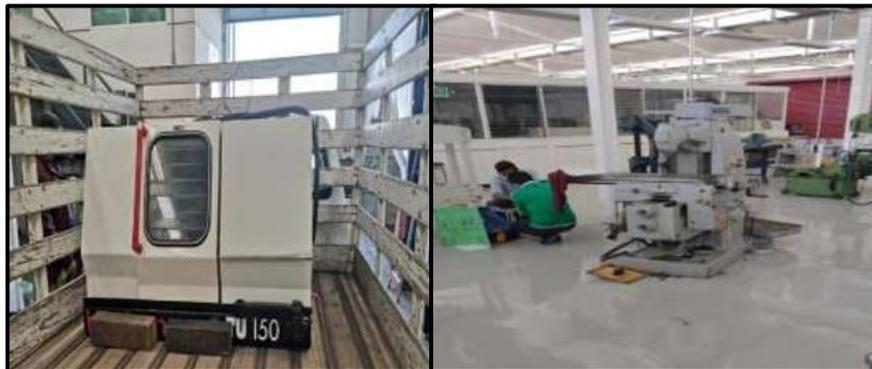
Ilustración 30. Actualización de fresadora Denford TRIAC VMC y torno CNC HARRISON TU-150.
