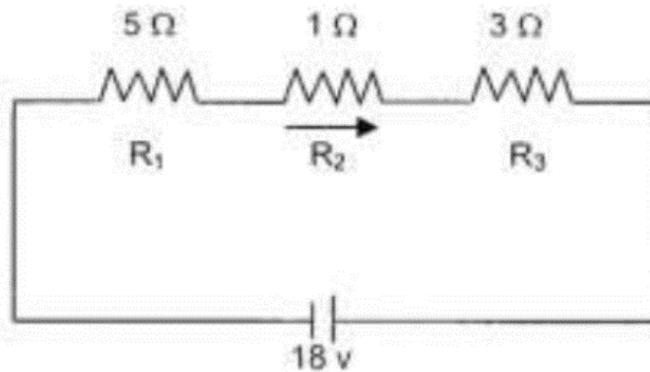
32. El alumno participante en esta evaluación une las terminales a-b del circuito en el sistema mediante un alambre de resistencia despreciable. Tomando en cuenta el corto circuito que produce, ¿qué corriente circula en la resistencia  $R_2$ ?
